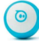
Le Sphero Mini est une sphère robotique compacte et interactive, dotée de capteurs multiples. Il se contrôle via une application, offrant une approche pédagogique de l'apprentissage du codage et de la résolution de problèmes par le jeu.
