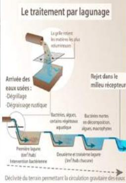
Nous avons découvert que le lagunage est une technique naturelle de traitements des eaux usées. Le nettoyage de l'eau se fait par auto-épuration comme dans une zone humide.
